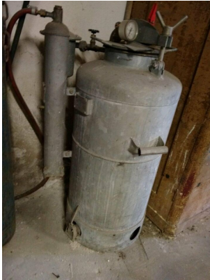
Das unterhalten von zwei ähnlich aussehenden Karbid Acetylenentwickler-Anlagen, allerdings mit schweren Karbid-Schubladen unten, war eines meiner Aufgaben in der Schlosserei..
