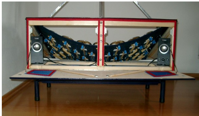
Geöffnete Deckelklappe mit Blick auf die Lautsprecher und in die noch leere Kabelkammer
