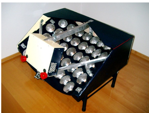
Die Seitenstreben sind mit dem Transportbügel verschraubt
