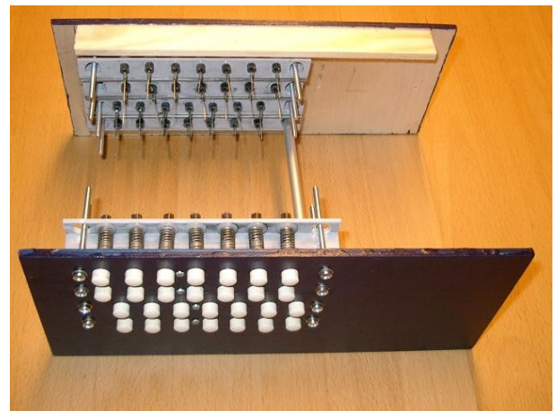
Seitenteile mit aufgeschraubten Tastenblöcken
