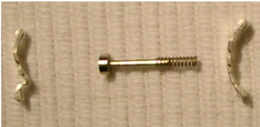
Ursprüngliche Kontakt-wippe / Stößel Federzusatz / umgeformte Kontakt-wippe
