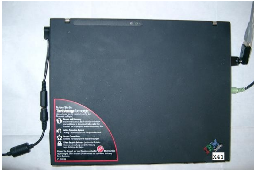
Das Netzteil- und USB-Kabel aus Platzgründen mit Winkelstecker erweitert
