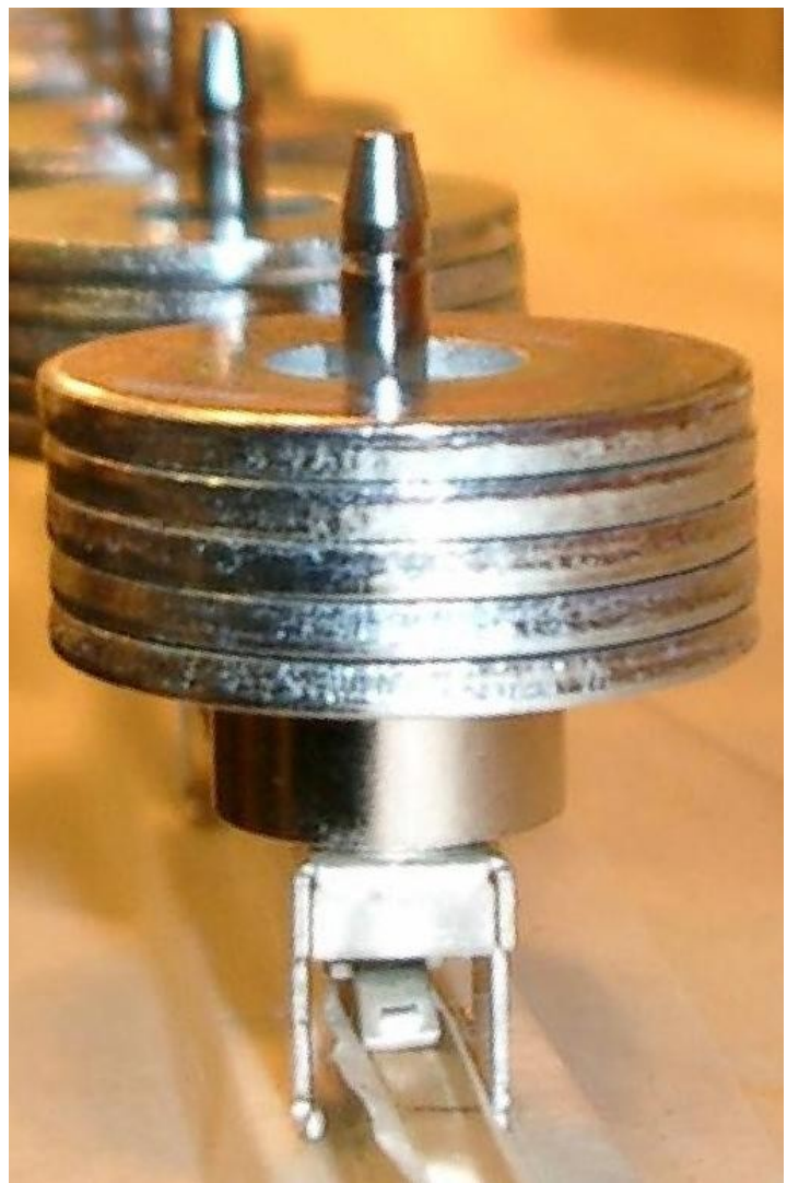
System für das Verleimen der Druckfeder mit der Kontaktwippe
