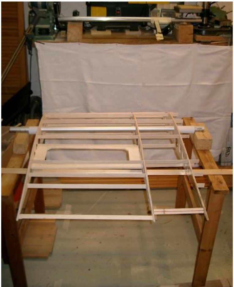
Die Holz-Federn in die Rippen-Schlitze geklemmt. Zwischen die Rippen-Enden eine bleibende Holz-Feder geklemmt und in die Aussparung für das Ruder eine temporäre Holz-Feder geklemmt (rot markiert). Die Rippen rechtwinklig ausgerichtet. Da alles etwas wacklig geblieben ist, habe ich zusätzlich ein Sperrholz-Rahmen erstellt und zwischen die Rippen eingepasst. Das ganze mit verdünntem Weissleim (Holzleim) verleimt.
