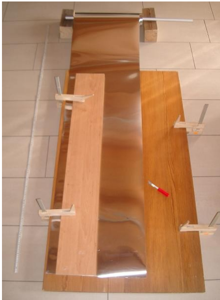
Auftrennen vom Alu-Dünnband wenn nur breitere Rollen als benötigt zur Verfügung stehen.
