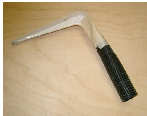
Der temporäre Kurbelgriff wird an die rumpfseitige Rippe geschraubt und vor herab fliessendem Harz geschützt.
