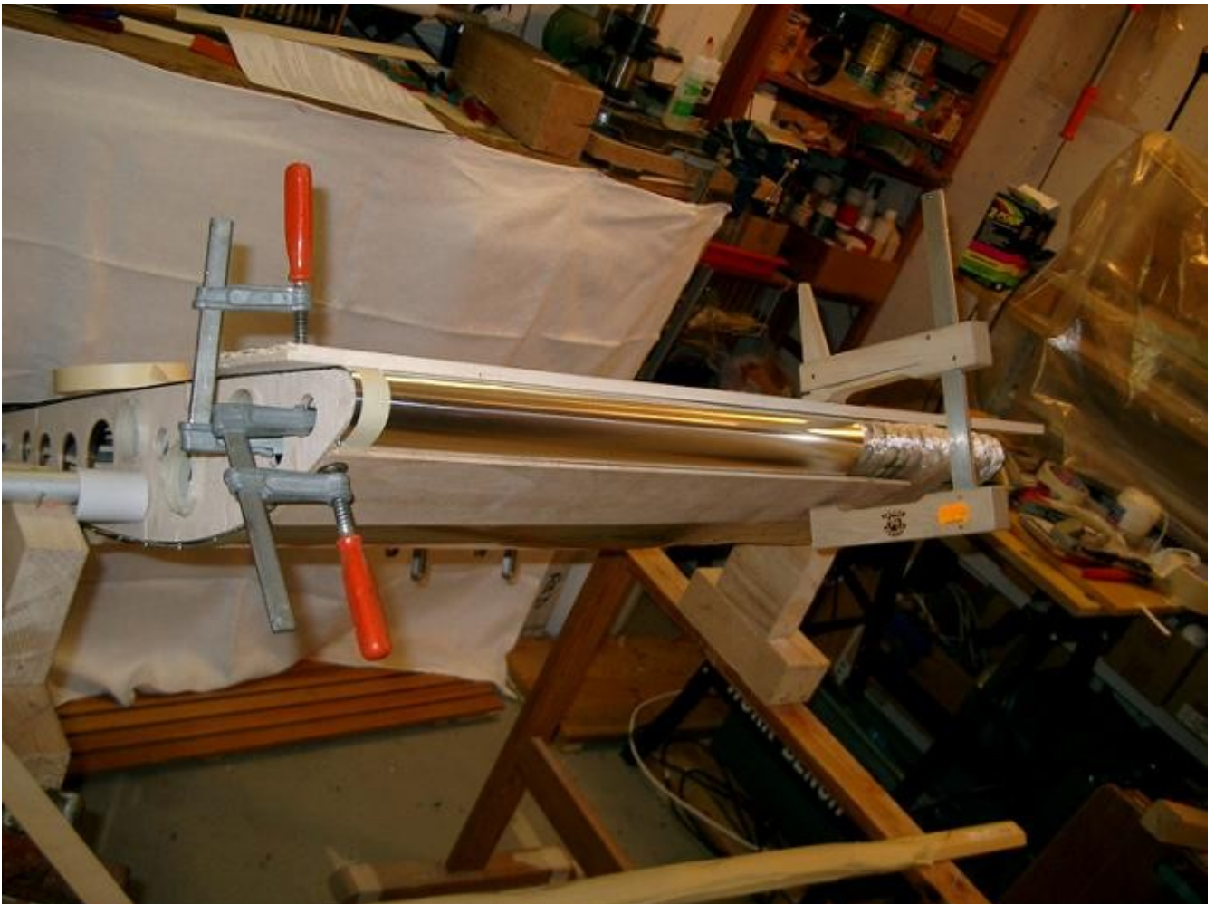
Das erste Alu-Dünnband auf der drehbaren Einrichtung aufgezogen. Dazu dieses ausgerichtet, über die Flügel-nase gelegt, fixiert und die Flügel-Oberseite aussen genagelt. Auf dem Bild ersetzen die Schraubzwingen die fehlenden Helfer - und taten dies gut.
