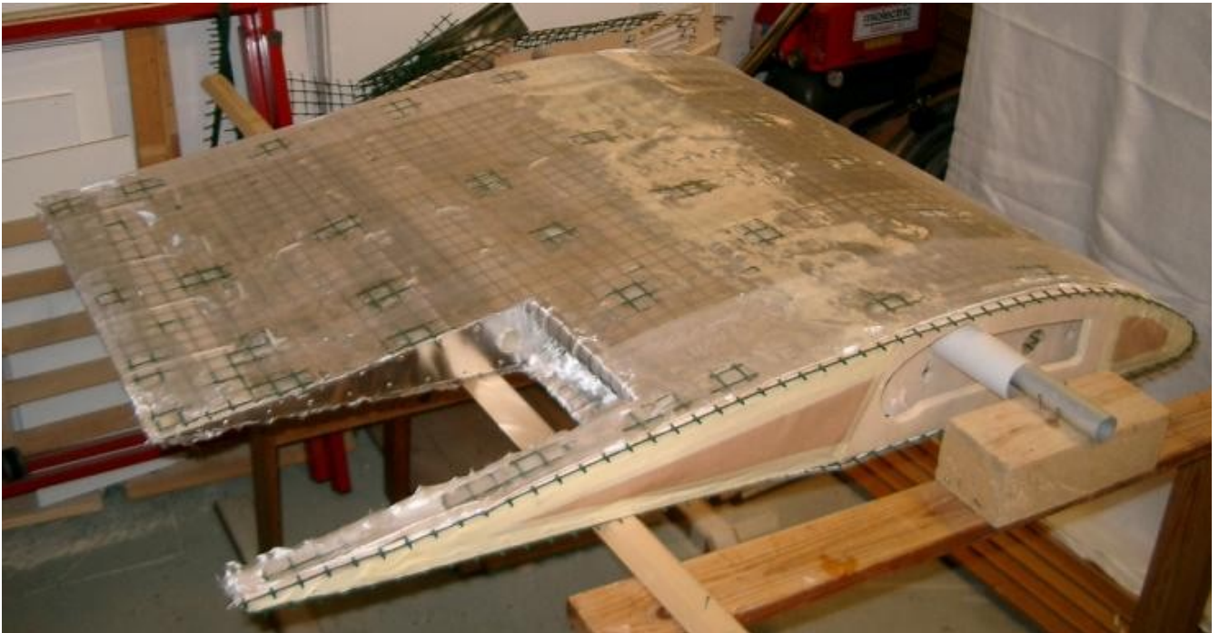
Den Flügel-Teil mit Glasfaser-Matte überzogen und diese mit Epoxyd-Harz punktweise am Plastik-Gitter fixiert. Die zwei Aussen-Rippe-Teile (Deckel) abgedeckt und der mittlere Teil durch den temporären Abstand-Halter (aus Rippe Nr. 13) ersetzt. Der Abstand-Halter wird noch mit Back-Papier oder Harz-Trenn-Papier eingefasst, die Ruder-Seitenrippen mit Maler Abdeckband abgedeckt.
