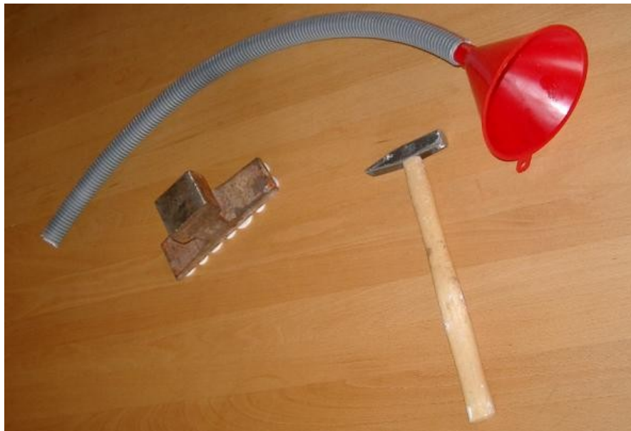
Harz-Einfüll- und Glas-Schnitzel-Verteil-System; ein Stück Eisenbahnschiene mit Filz-Schutz zum entgegenhalten beim Nageln am Flügel (Eisenbahnschiene gibt es weltweit 1,4 Millionen Kilometer, davon werden nur zirka 5 Zentimeter benötigt); kleiner Hammer für die Stiften.
